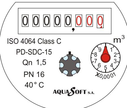
La versión especial del PD-SDC (E4) Medidor de Agua está equipado con un conjunto de interruptor de láminas que puede ser conectado a los sistemas de lectura remota.
